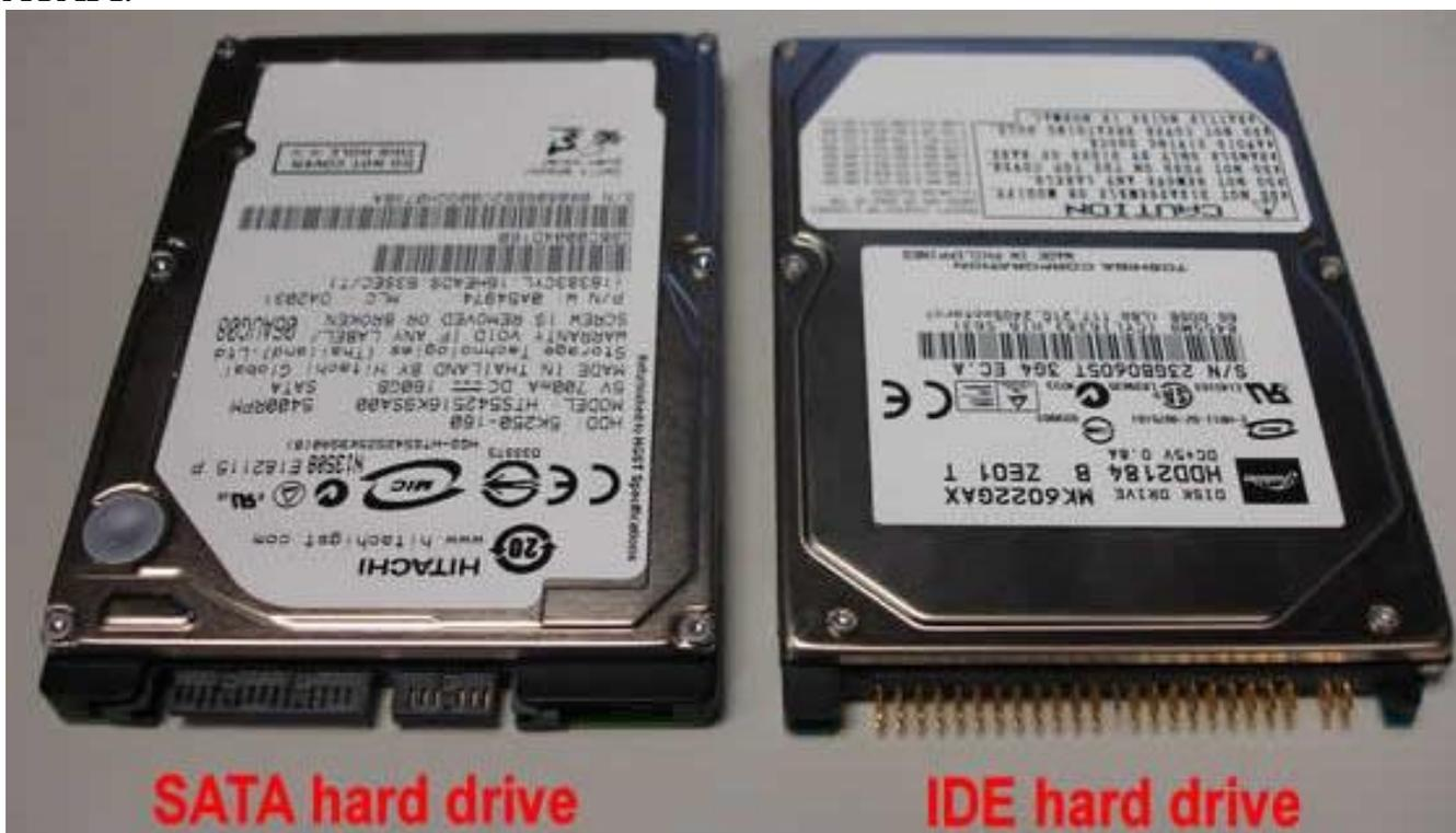
**SATA (Serial ATA)** – последовательный интерфейс обмена данными с накопителями информации. Для подключения используется 8-pin разъем. SATA является развитием параллельного интерфейса ATA (IDE), который
