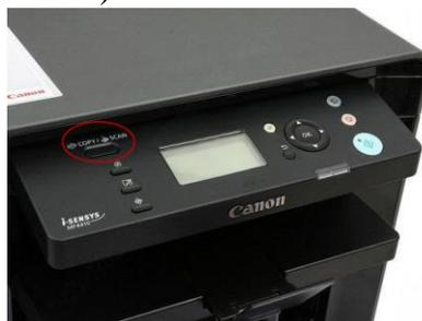
Рисунок 29.6 – Кнопка переключения на сканирование
